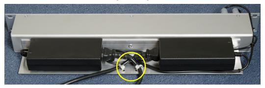
3. Verwenden Sie vier Schrauben, um den PDS0800-HD im Einbaurahmen zu befestigen. Beachten Sie die Vorgaben vom Hersteller des Einbaurahmens.
