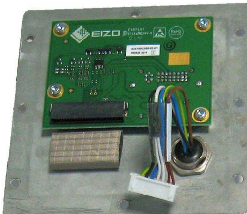
Fig.: Removed input module
